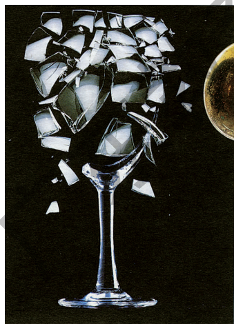
图 1-6-7 某些乐器发出与玻璃杯固有频率相同的音乐，如果该音乐持续不断，则玻璃杯可能因发生共振而破碎
