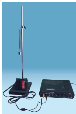
图 1-1-3 用运动传感器测量垂直悬挂的弹簧振子的运动
