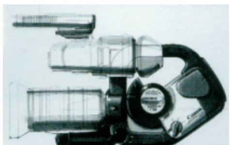
(6) 通过对草图的讨论评估后,最终决定发展方向,机壳尾端上翘,使机身和大型的镜头及取景器取得平衡。
