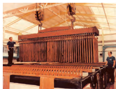
图 2-16 铜的电解精炼
