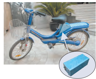
图 2-11 用于电动自行车的镍氢电池
