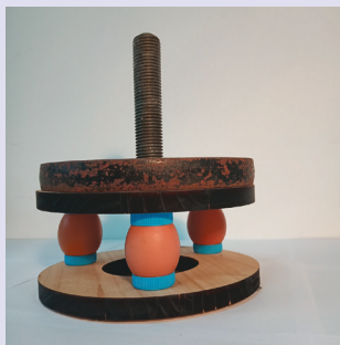
图 1-15 鸡蛋受力试验
