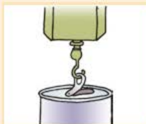
拉断力测试 铝制易拉罐等
