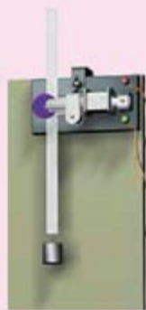
图2.5-1 用打点计时器研究自由落体运动
