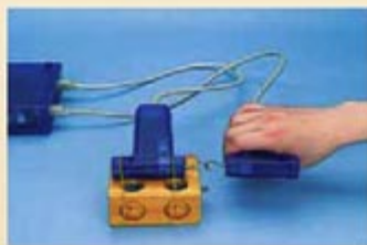
图4.5-6 用传感器显示运动中两物体间的作用力和反作用力
