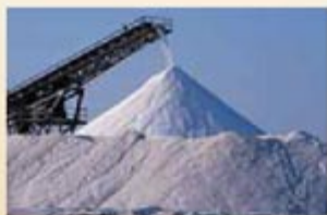
图 3.3-3 传送带靠静摩擦力把货物送到高处
