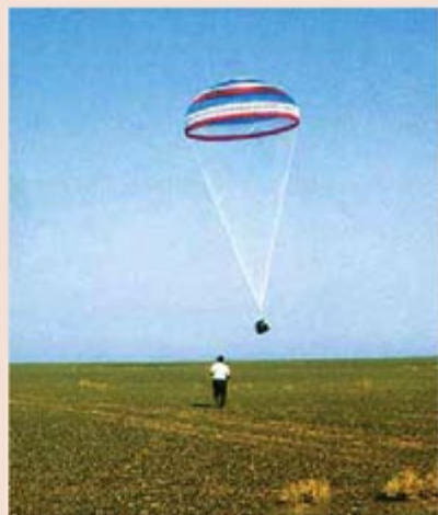
图3.3-8 神舟号返回舱的空降试验
