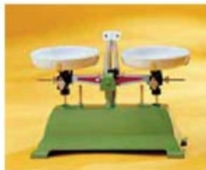
图实-8 假如这台天平的右臂比左臂稍长，在操作无误的情况下，会引起什么系统误差？
