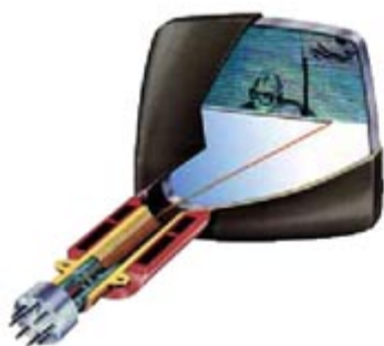
图 0-2 电视机显像管的剖面图
