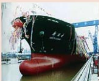
图 3.3-9 轮船的水下部分呈流线型
