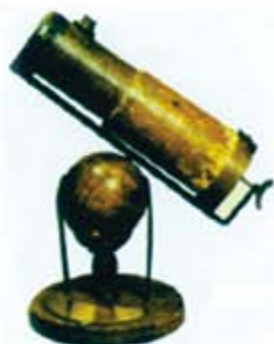
牛顿制作的反射望远镜
