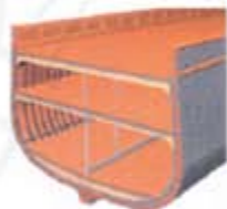
19世纪木铁结构夹板船的构造
