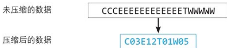
图 1.2.10 简单的无损压缩编码示意图
