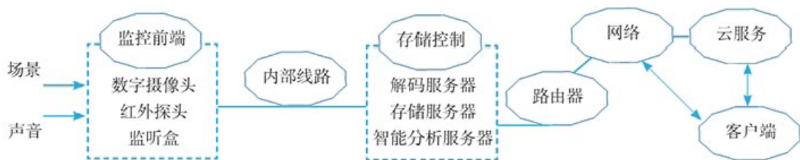
图 2.2.8 小型监控系统的工作过程
