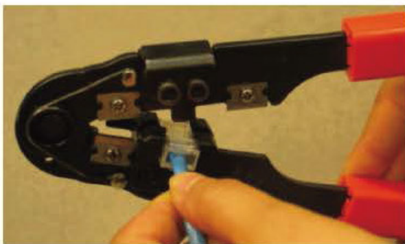
图 1-1-5 用压线钳压紧水晶头的金属压片
