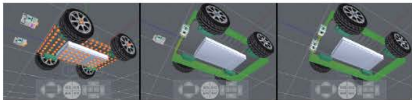
图 5-5-4 安装灰度传感器
