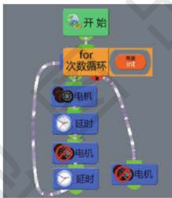
图 5-4-10 “for 次数循环”模块循环体
