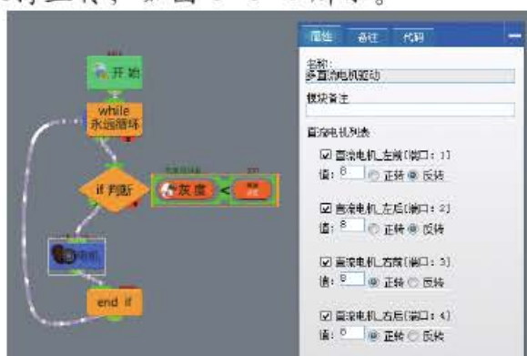
图 5-5-8 设置电机左转
