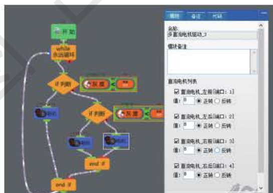
图 5-5-10 设置电机直行
