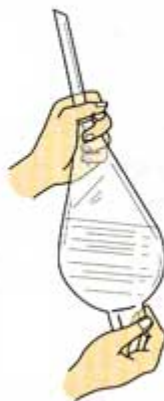
图 1-7 倒转分液漏斗
