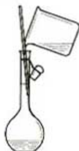
图 1-16 向容量瓶中转移溶液
