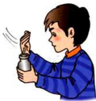
图 4-15 闻气体时的正确操作
