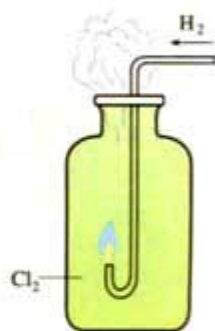
图 4-16 \text{H}_2 在 \text{Cl}_2 中燃烧
