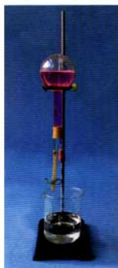
图 4-31 氨溶于水的喷泉实验
