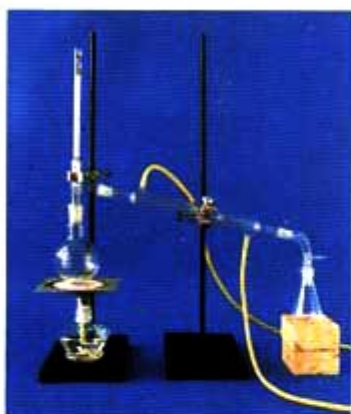
图 1-4 实验室制取蒸馏水的装置
