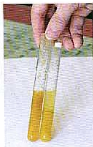
图4-1 两个装有果汁的试管，右边的试管中加入了果胶酶，而左边的没有加入
