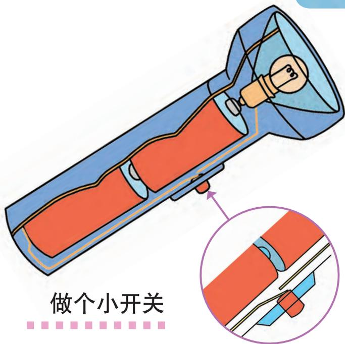
观察手电筒的构造。电池和小灯泡是怎样安装的？电路中电流的路径是怎样的？试着标出电流的路径。
