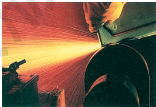
图 2-6 火花沿砂轮的切线方向飞出
