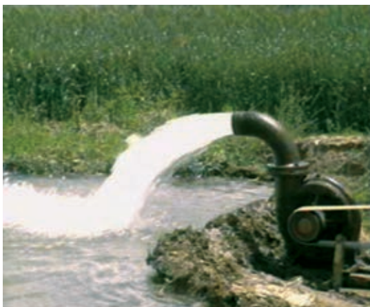
图 2-35 正在抽水的离心式水泵
