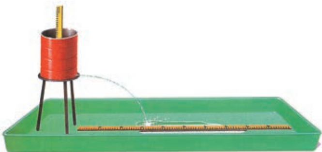
图 1-12 研究水柱的射程
