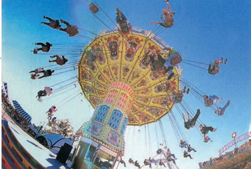
b 坐在旋转椅上的人，随着转速的增大，旋转半径也越来越大
