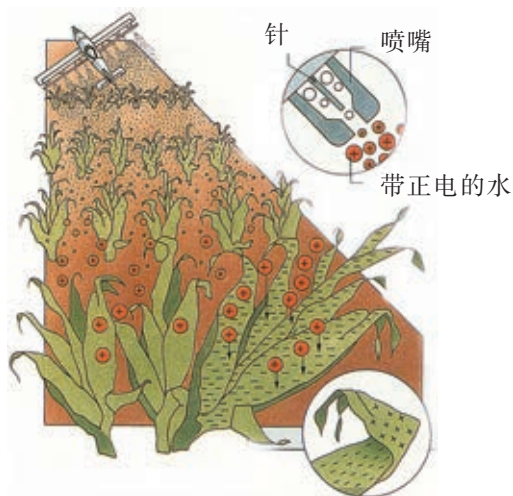
图 1-16 利用静电喷洒农药示意图
