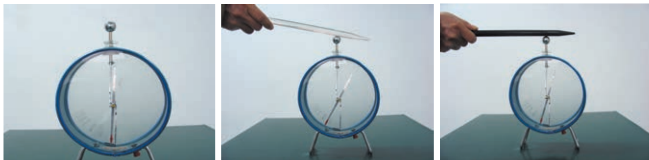
图 1-4 用验电器检验物体是否带电
