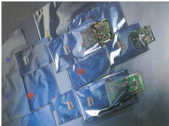
图 1-19 用抗静电材料包装电子产品
