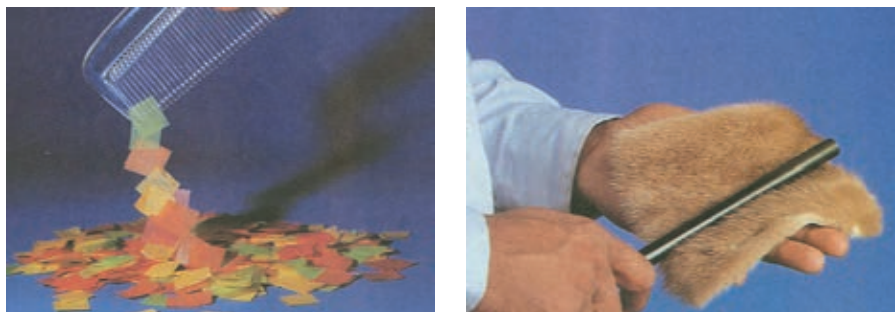
a 梳过干燥头发的塑料梳子能吸引轻小物体 b 用毛皮摩擦橡胶棒
