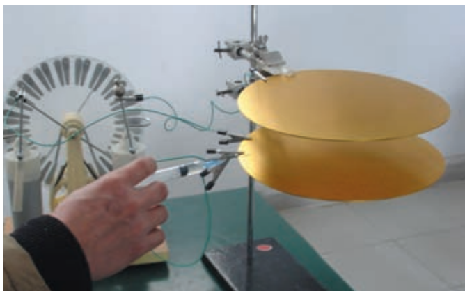
图 2-38 观察带电油滴在匀强电场中的偏移
