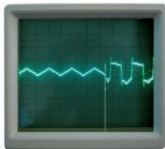
图 1-46 日光灯起辉过程中,灯管两端的电压波形 左端是灯管两端点亮时的波形,右端是正常发光时的波形。请注意两波形衔接处的脉冲波(示波器 Y 轴灵敏度为每格 200 V)。
