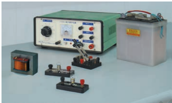
图 2-26 探究电感器对交变电流的阻碍作用
