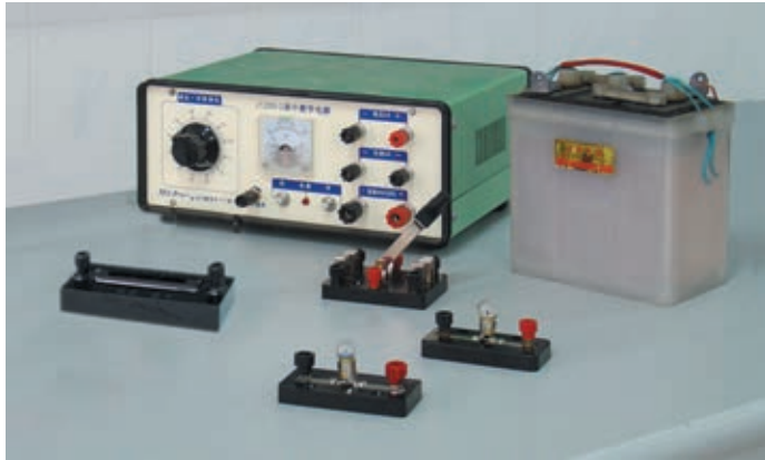
图 2-24 探究电阻器对交变电流的阻碍作用
