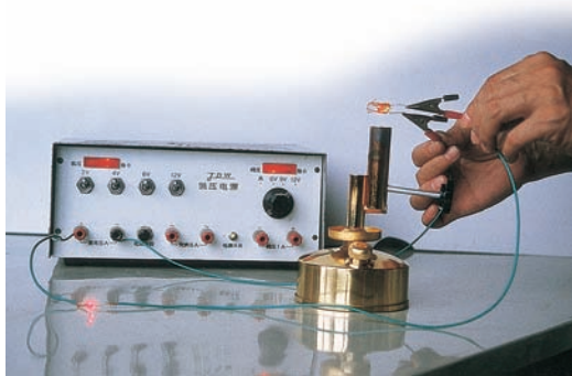
图4-30 烧红的玻璃能导电
