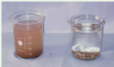
图1-52 泥浆水中加凝聚剂
