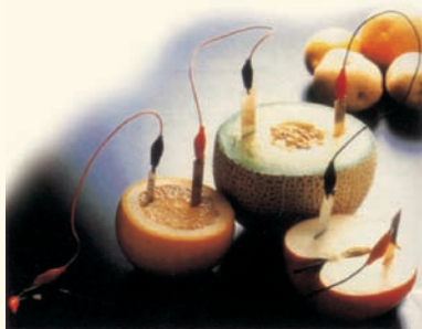
图4-47 水果电池使二极管发光
