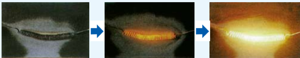
图4-81 电热丝通电后的变化
