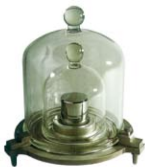
图4-12 保存于巴黎国际计量局内的国际千克原器
