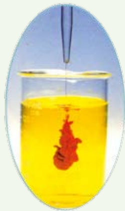
图4-83 氢氧化钠溶液与 氯化铁溶液混合
