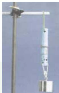
图4-10 铅柱粘合实验
