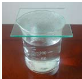
图4-62 水蒸气液化实验
