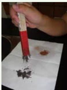
图4-82 磁铁吸铁粉和铁锈
