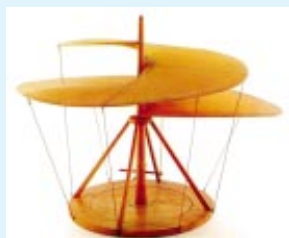
根据达·芬奇所画直升机螺旋部草图复原的模型
