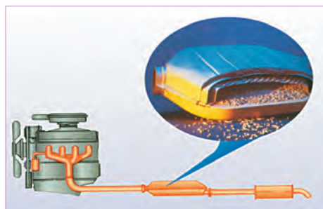
图 2-9 催化剂用于汽车尾气的净化
