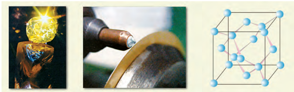
图 3-27 金刚石、用金刚石制成的钻头和金刚石晶胞
